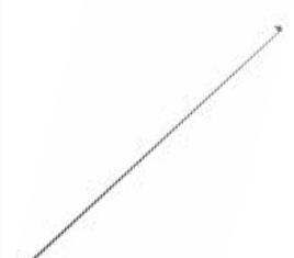
**VSW08 Диагональ 3,88 м** обеспечивает жесткость лесов, что крайне важно для безопасности при проведении высотных работ. Диагонали крепятся клиновыми замками к стойкам-лестницам с внешней стороны конструкции.
